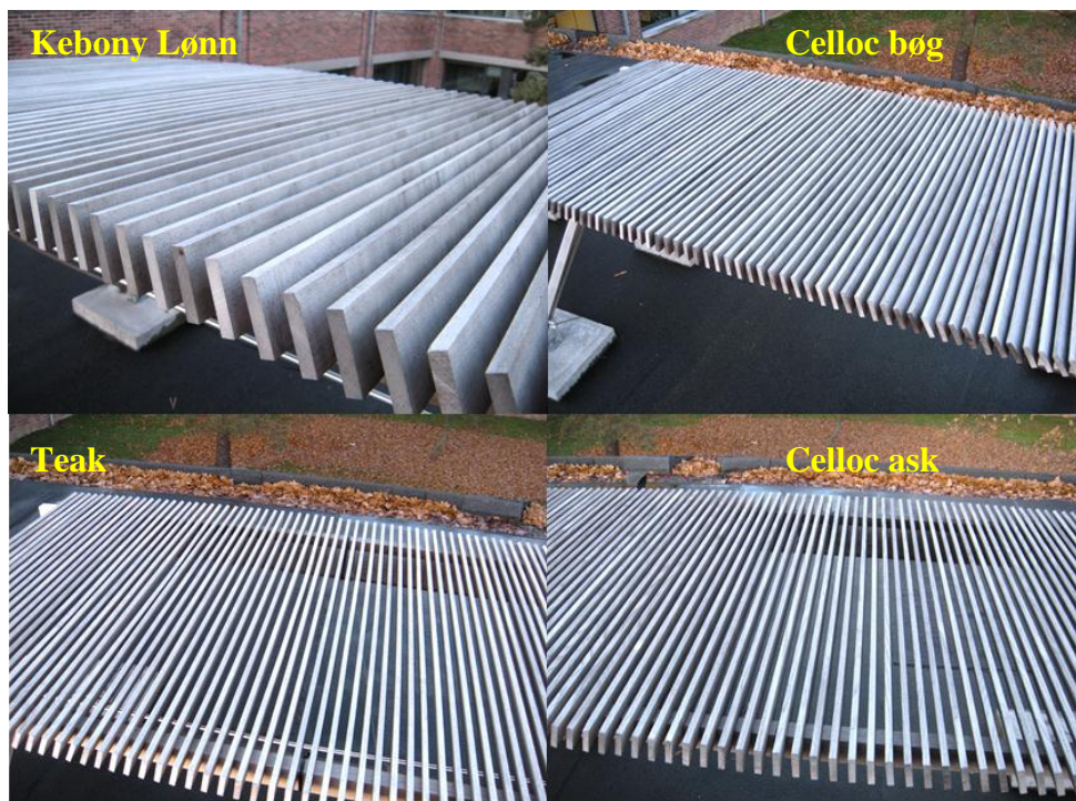
Figur 2: ø.tv.: furfuryleret ahorn, ø.th.: varmebehandlet bøg, n.tv.: Teak, n.th.: varmebehandlet ask efter 10 måneders eksponering (jan. – nov. 2012, Taastrup, Danmark)
