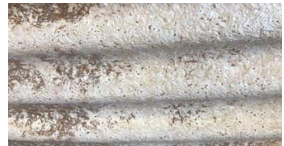
Eksempel på vægmateriale fremstillet af DENIM. Materialet kan indgå som del af skillevæg
